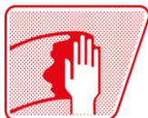
Befeuchten Sie ein sauberes Tuch gründlich mit Wandabase SB Degreaser und entfetten/reinigen Sie die Oberfläche durch gleichmäßiges Reiben.
